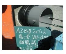
☆ 外水圧0. 15MPa 漏水なし
